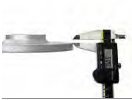
Darstellung Aussenfase 5x45° / Outer bevel 5x45°
