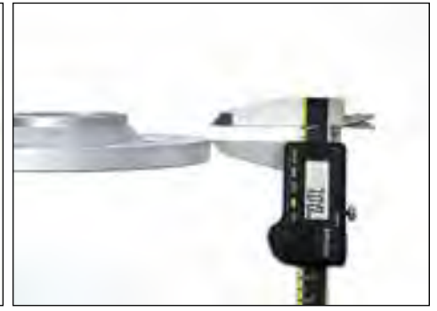
Darstellung Aussenfase 7x45° / Outer bevel 7x45°
